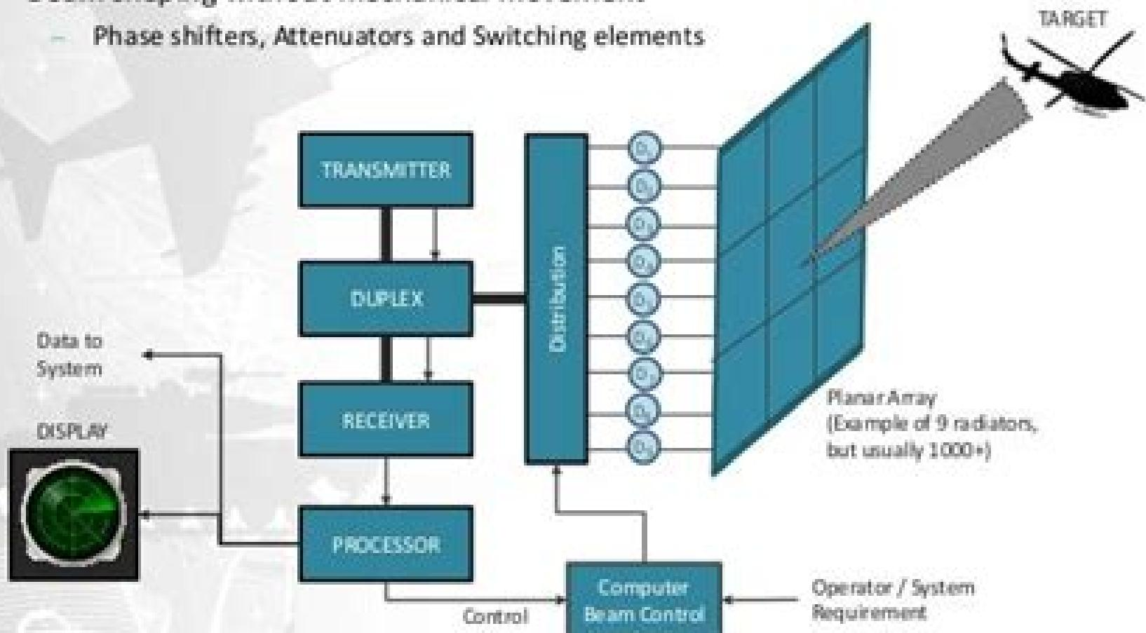
**HIGH-POWER VARIABLE PHASE SHIFTERS AND ATTENUATORS**
