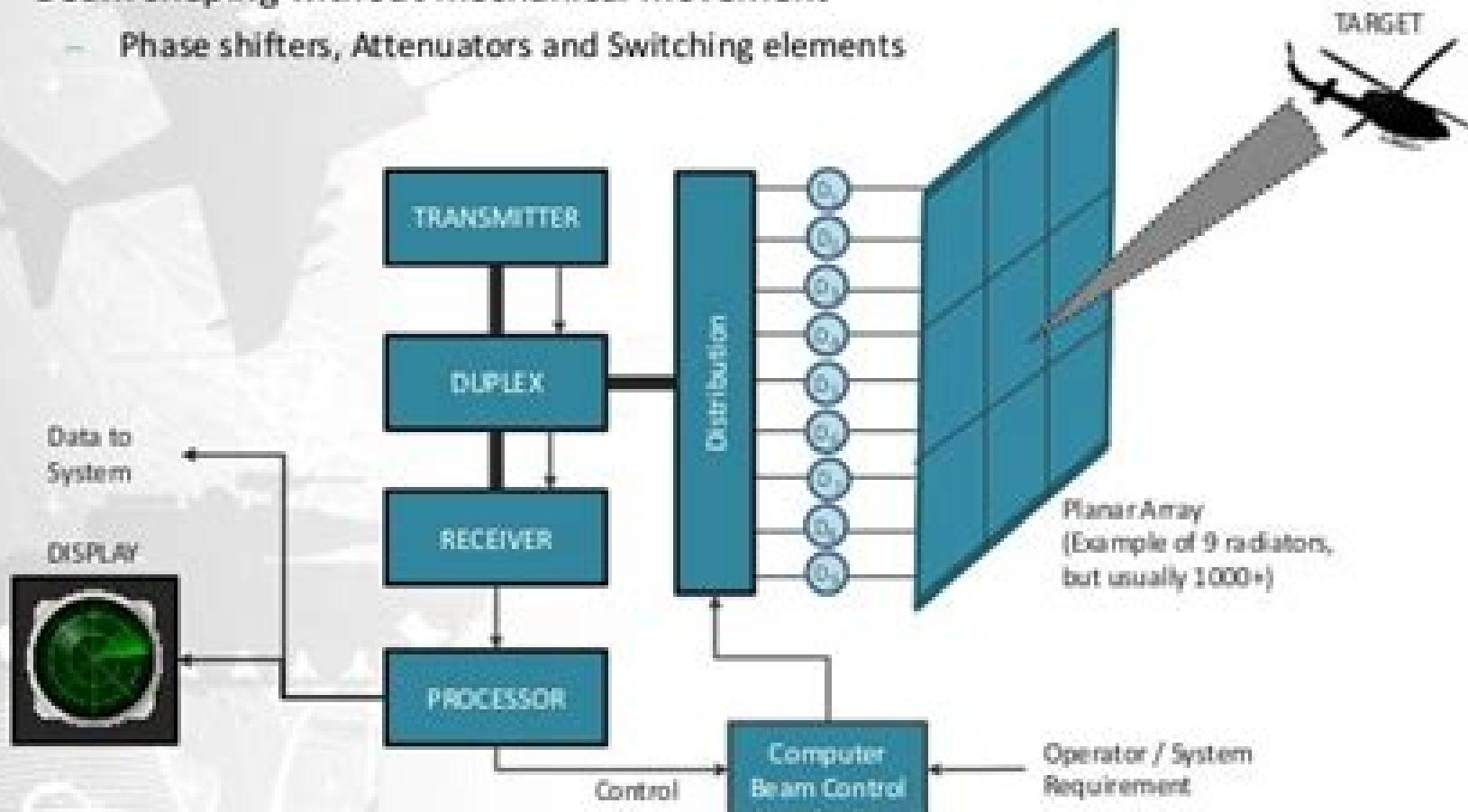
**HIGH-POWER VARIABLE PHASE SHIFTERS AND ATTENUATORS**
